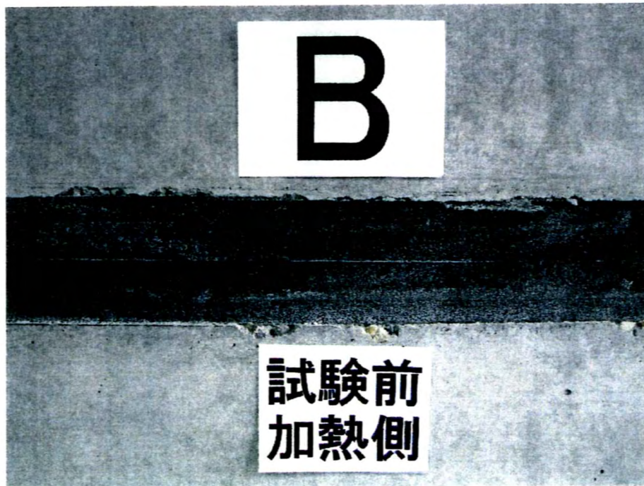
写真-8 試験前の水平スリット部（加熱側，屋内側）の状況 （試験体記号B）
