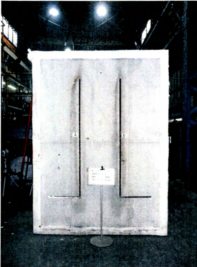
写真-11 試験後の加熱側の状況
