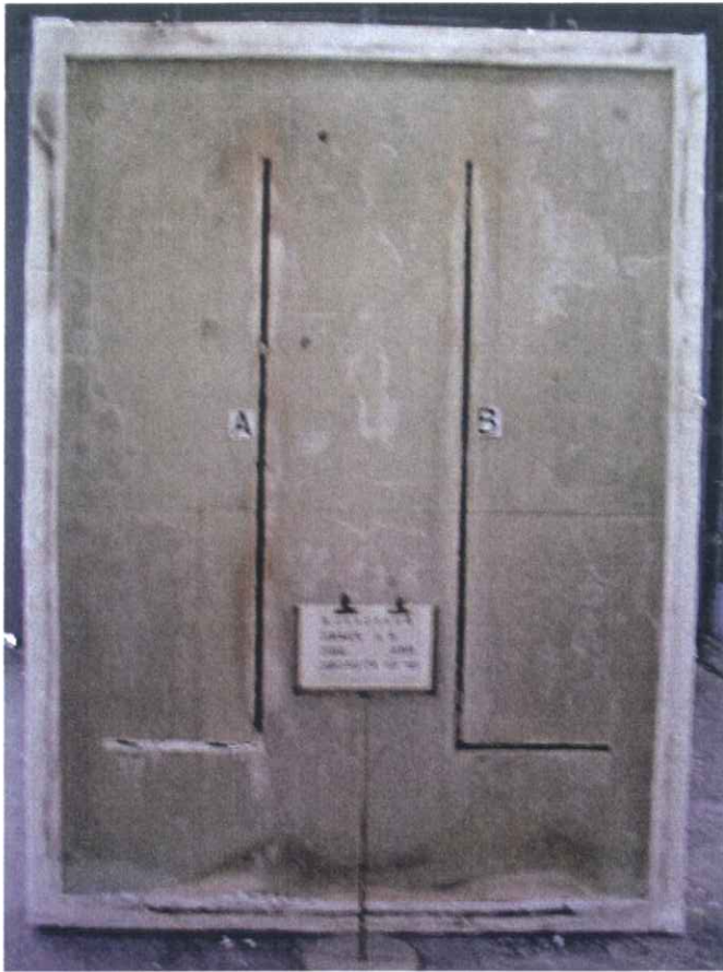
写真-11 試験後の加熱側の状況
