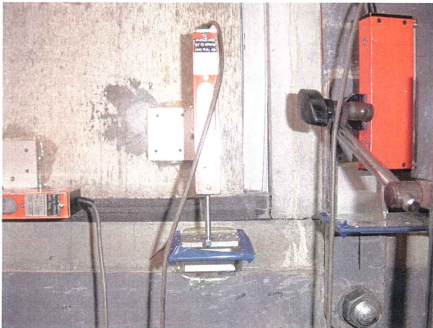
写真-8 層間変形角 R_o=1/150 rad 時(2C 時)の状況
