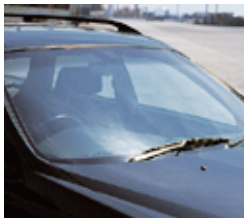
自動車のフロントガラス (ガラス間にフィルム化したPVBを使用し接着) 写真提供：株式会社クラレ
