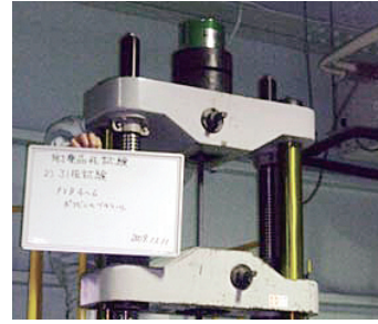
アムスラ型試験機による付着試験
