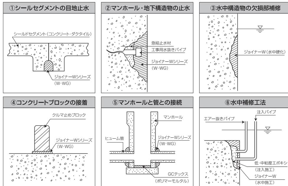
※水中・湿潤・湧水面の短時間での補修に適しています。※個別条件はお問合せください。
