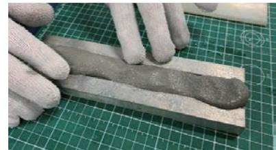
丸棒状に成形後所定の隙間に充填する
