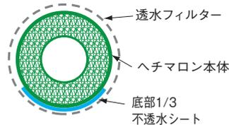
施工時の断面<内部充填型>
