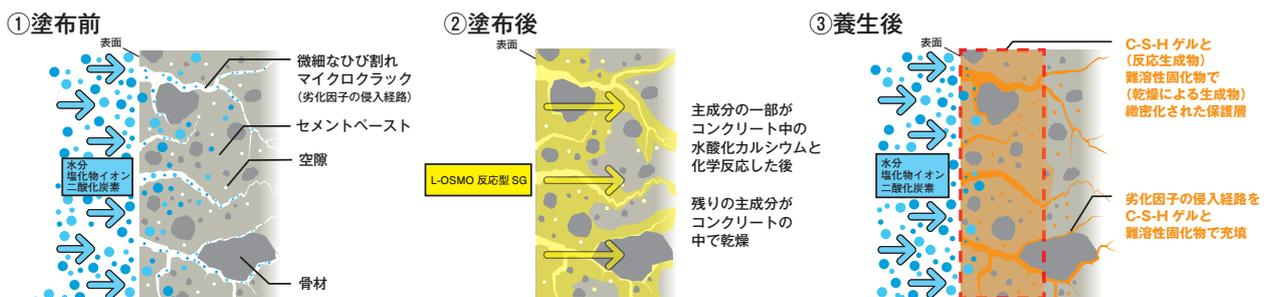
主成分と水酸化カルシウムの反応生成物(C-S-Hゲル)と主成分の乾燥による生成物(難溶性固化物)によりコンクリートを緻密化(改質)することで劣化因子(水分・塩化物イオン・二酸化炭素)の侵入を抑制します。
