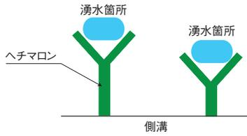
② 法面全面の湧水対策、もしくは湧水箇所がわかりにくい場合
