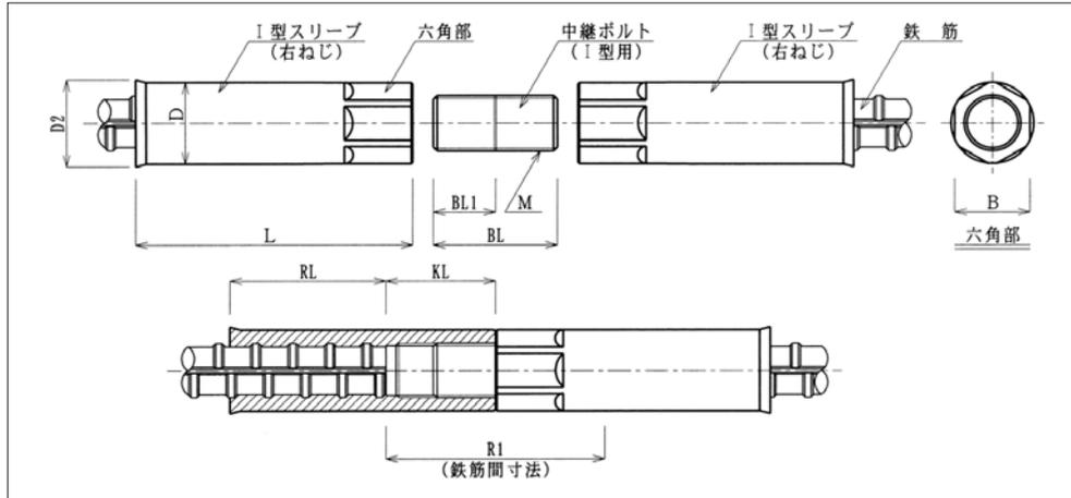
接合する鉄筋の一方が回転でき、軸方向に移動可能な場合。
