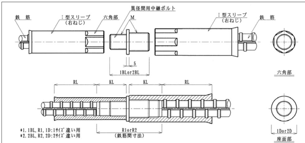
接合する鉄筋の一方が回転できて、軸方向に移動可能な場合。
