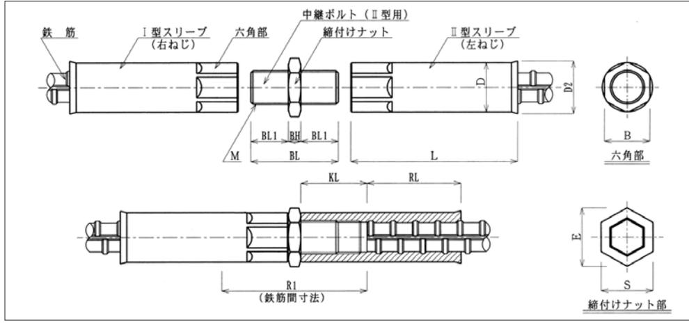
接合する鉄筋が回転出来ないが、一方が軸方向に移動可能な場合。
