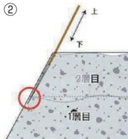
※2層目も1層目と方法は同じですが、1層目にピカコンの先端が5cm位挿入するようにしてください。
