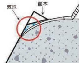
※ピカコンは型枠に沿わせて使用しなければ効果が少ない、しかし天端では面木があるため左図○部に気泡が残ります。この気泡を除去するのがピカコンIIです。
