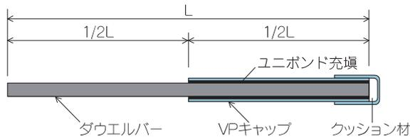
●充填セットでは、ダウエルバーとVPキャップが充填材で一体化しています。
