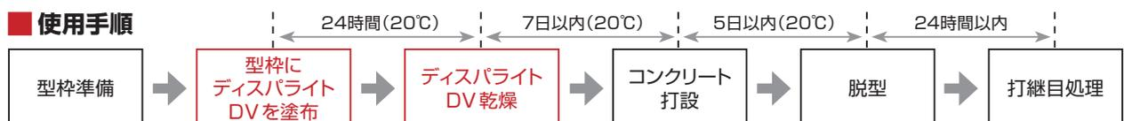
ディスパライトDVは、コンクリートの鉛直打継用に開発した打継目処理剤です。
