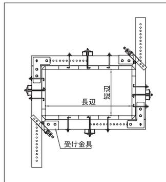
※長方形の柱は、長辺側に受け金具がくるように配置し、パワードコラム本体を設置してください。
