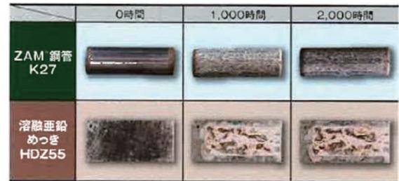
※1)「ZAM」は、日新製鋼株式会社が開発した溶融亜鉛Zn-アルミニウムAl-マグネシウムMg合金めっき鋼板の商品名です。
