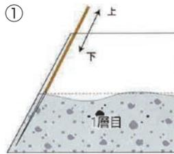
コンクリート打設時に型枠表面に沿ってピカコンを上下に動かしながら差込、上下に動かしながら引き上げる。
